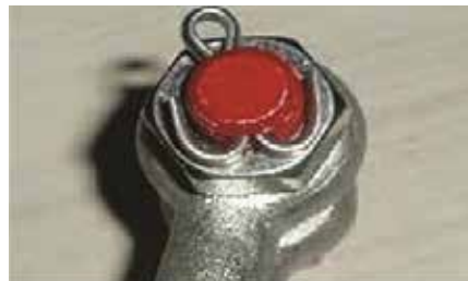
Splittpinne montert i sjakkkelbolt
